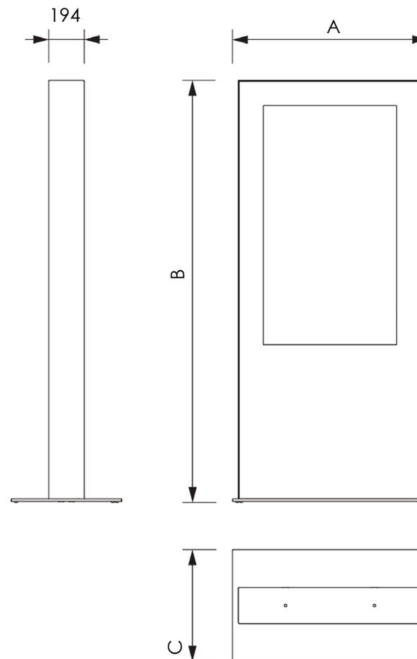
Totem con monitor su entrambi i lati, posizionati dietro ad un frontale in vetro temperato ad alta sicurezza per proteggere lo schermo da atti vandalici. Base pesante in acciaio 10 mm per garantire un'ottima stabilità; è anche possibile fissare la base a terra usando viti di fissaggio. I colori standard sono nero, bianco o altri colori RAL su richiesta. Può essere applicato un foglio touch per la funzione touch screen.
