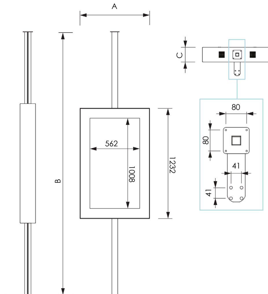
Pannello digitale per vetrine con parte frontale realizzata in vetro temperato di sicurezza e retro protetto da una copertura incernierata verniciata a polveri. Lo schermo può essere posizionato su un piedistallo in acciaio, o su un montante fissato a pavimento o a soffitto. Non può essere installato su locali che superano i 40 gradi Celsius. È orientabile sia in verticale che in orizzontale. Colori standard nero e bianco, altri colori RAL su richiesta.
