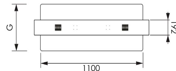
Pannello digitale per vetrine con parte frontale realizzata in vetro temperato di sicurezza e retro protetto da una copertura incernierata verniciata a polveri. Lo schermo può essere posizionato su un piedistallo in acciaio, o su un montante fissato a pavimento o a soffitto. Non può essere installato su locali che superano i 40 gradi Celsius. È orientabile sia in verticale che in orizzontale. Colori standard nero e bianco, altri colori RAL su richiesta.
