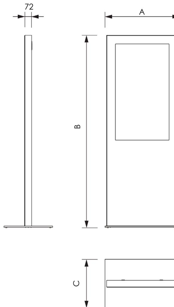
Totem sottile con monitor, posizionato dietro ad un frontale in vetro temperato ad alta sicurezza per proteggere lo schermo da atti vandalici. Base pesante in acciaio 10 mm per garantire un'ottima stabilità; è anche possibile fissare la base a terra usando viti di fissaggio. I colori standard sono nero, bianco e altri colori RAL su richiesta. Può essere applicato un foglio touch per la funzione touch screen.
