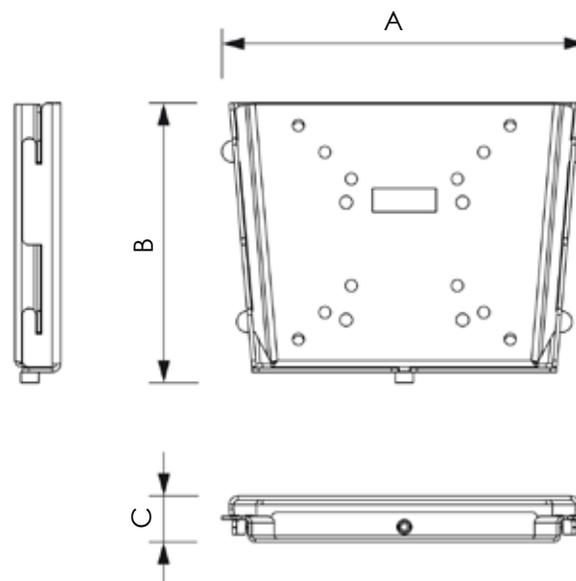
Supporto VESA universale per fissaggio display a parete. Struttura in acciaio verniciata a polveri nere. Pronto per il montaggio con fori predisposti per il fissaggio con viti ad una parete o superficie verticale. Dimensioni 50mm, 75 mm, 100 mm per monitor fino a 22".
