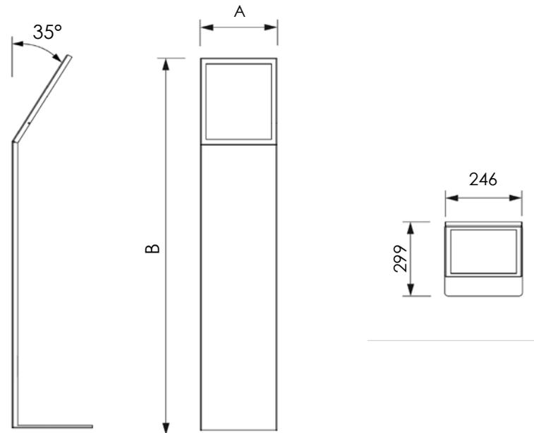
Leggio da terra autoportante in metallo spessore 4 mm verniciato con base a L. Disponibile con una tasca in plexiglass porta comunicazioni in formato A4 o con una cornice a scatto ad angoli vivi per formati A4. Possibilità di personalizzare la struttura con grafica ad hoc in vinile.
