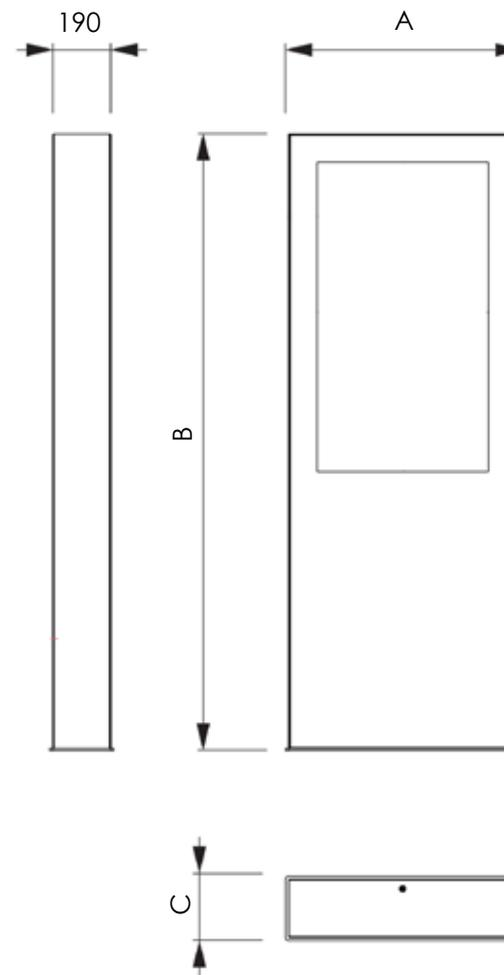
Struttura durevole facile da utilizzare per segnaletica in esterno con schermi Samsung OH48 e OH56. Schermi con grado di protezione IP56 e pannello frontale in vetro protettivo IK10. Sistema di auto-raffreddamento. Retro con copertura incernierata in metallo verniciata a polveri dotatate di serratura. Pronto per funzionamento 24x7. Facile fissaggio a terra e collegamento elettrico. Caricamento video attraverso porta LAN o USB, o collegamento WIRELESS. Monitor non incluso.
