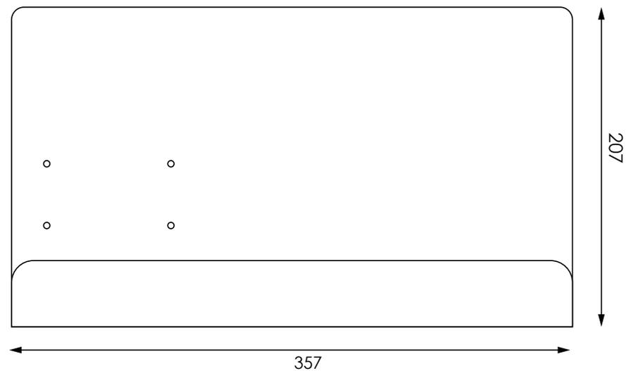
Struttura in PMMA estruso (plexi) trasparente spessore 3 mm porta dispenser e porta guanti. Fascette per il fissaggio del dispenser incluse.
