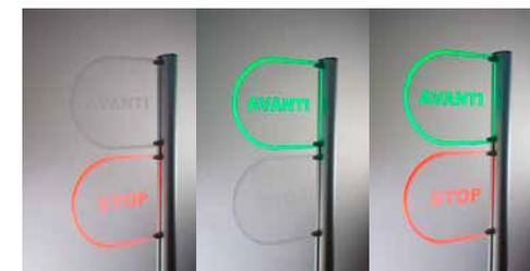
Espositore a semaforo per controllo accessi composto da montante ovale diametro 70 mm in alluminio anodizzato silver, spessore 4 mm. Base in metallo verniciata a polveri silver, spessore 6 mm, diametro 450 mm. N. 2 targhe in plexiglass trasparente, spessore 8 mm, con incisione scritte *Stop* e *Avanti*. Led Rgb con controllo remoto per attivare la luce rossa (*Stop*) e verde (*Avanti*). Alimentatore 220V, lunghezza cavo 200 cm.
