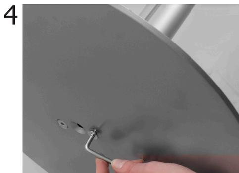
4 **Fissare la base al montante, avvitando le viti M8** con l'aiuto della chiave a brugola.
