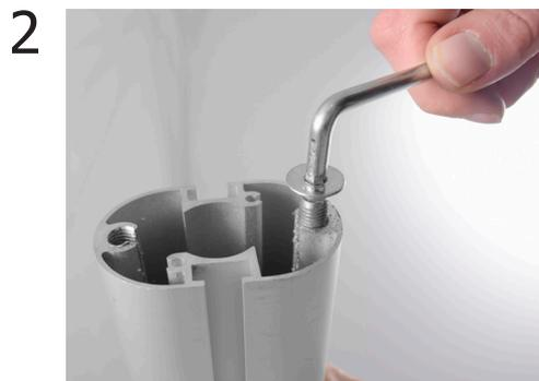
2 **Rimuovere le due viti M8** che si trovano nella parte inferiore del montante con l'aiuto della chiave a brugola.
