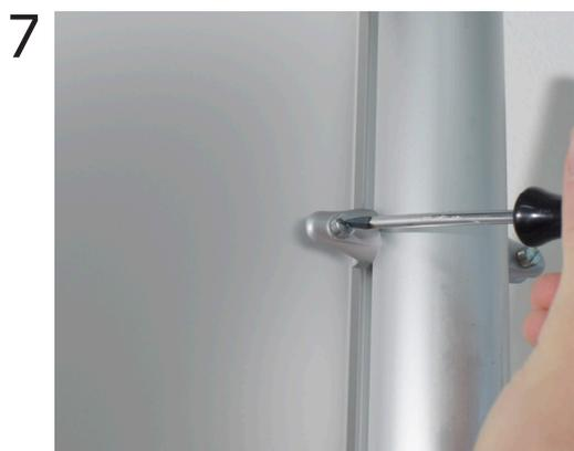
Con l'aiuto di un cavviavite a testa piatta, **avvitare i grani** posti sul retro degli attacchi a bandiera per fissare la vela.
