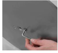
Posizionare il montante dall'altro lato della base e **fissarlo avvitando le viti M8** con l'aiuto della chiave a brugola.
