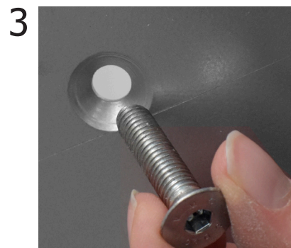
3 Inserire le viti M8 tolte in precedenza nei fori presenti sulla base (lato con foro svastato verso il basso).
