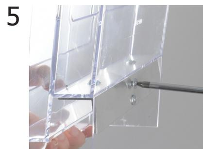
5 **Allentare le due viti** poste sulla staffa posteriore dell'espositore con l'aiuto di un cacciavite a croce. **Attenzione:** non svitare completamente le viti (fermarsi ad un giro dalla fine).
