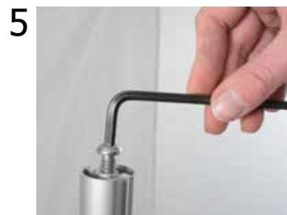
**5** **Svitare la vite M8** posta nella parte superiore del montante.
