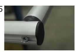
Ripetere il procedimento per il montante superiore. Inserire i tappini nella parte superiore dei montanti più lunghi con l'aiuto di un martello.
