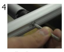
Infilare il montante corto nella vite e fissare con una chiave a brugola. Ripetere dalla parte opposta.
