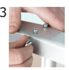
Fissare il piedino al profilo avvitando la vite nella parte inferiore del piedino.
