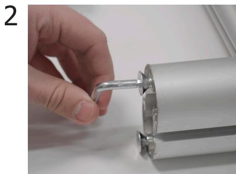
**Rimuovere le due viti M8** che si trovano nella parte inferiore del montante con l'aiuto della chiave a brugola.
