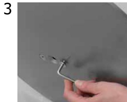
3 Posizionare il montante dall'altro lato della base e **fissarlo avvitando le viti M8** con l'aiuto della chiave a brugola.
