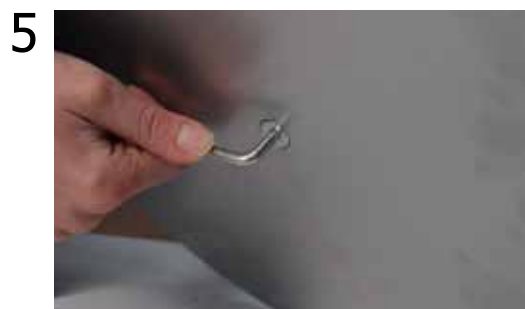
5 Stringere la vite M8 alla base con l'aiuto della chiave a brugola.
