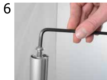
6 Con la brugola svitare la vite M8 dalla parte superiore del montante.
