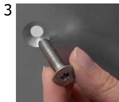
3 Inserire la vite M8 tolta in precedenza nel foro presente sulla base (lato con foro svasato verso il basso).
