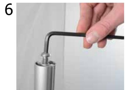
6 Con la brugola **svitare la vite M8** dalla parte superiore del montante.
