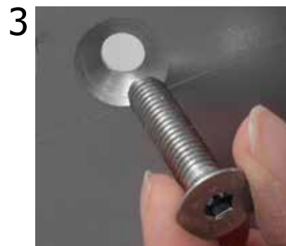
3 Inserire la vite M10 tolta in precedenza nel foro presente sulla base (lato con foro svasato verso il basso).
