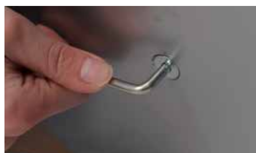
4 Unire il montante con la cornice a scatto alla base avvitando la vite con l'aiuto della chiave a brugola.
