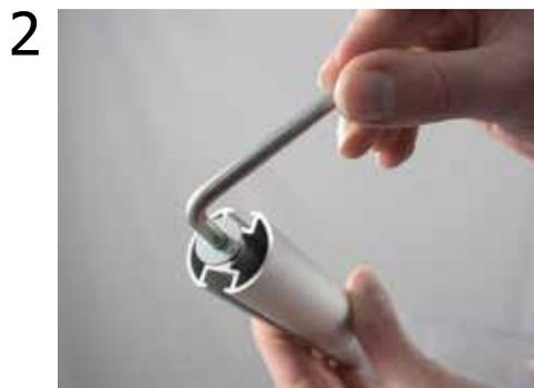
2 Con la brugola **svitare la vite M8** dalla parte inferiore del montante.
