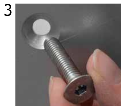
3 Inserire la vite M8 tolta in precedenza (il lato con il foro svasato va verso il basso).
