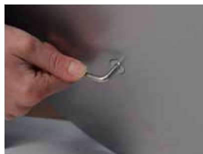
4 Unire il montante alla base avvitandola vite con l'aiuto della chiave a brugola.
