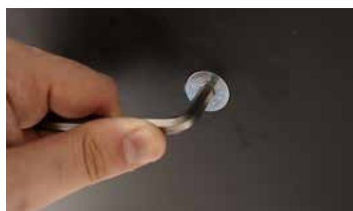
4 Unire il montante con le staffe regolabili alla base avvitando la vite con l'aiuto della chiave a brugola.
