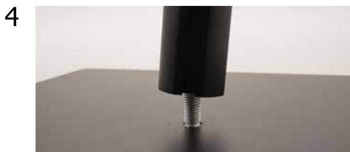
4 Unire il montante con le staffe regolabili alla base avvitando la vite con l'aiuto della chiave a brugola.
