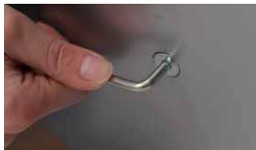
**Unire il montante alla base** avvitando la vite con l'aiuto della chiave a brugola.
