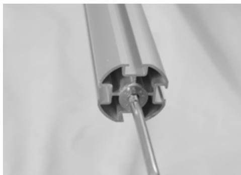
Con la brugola **svitare la vite M10** dalla parte inferiore del montante.
