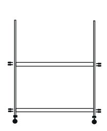
**Fissare le ruote ai piedini** e di conseguenza fissarli ai montanti laterali
